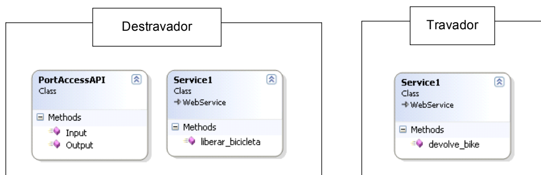
Fig. 69 Diagrama de classes dos Web Services . A classe PortAccessAPI do Destravador permite o acesso à porta paralela do computador, para comunicação com o circuito de acionamento/sensoriamento da estação.
